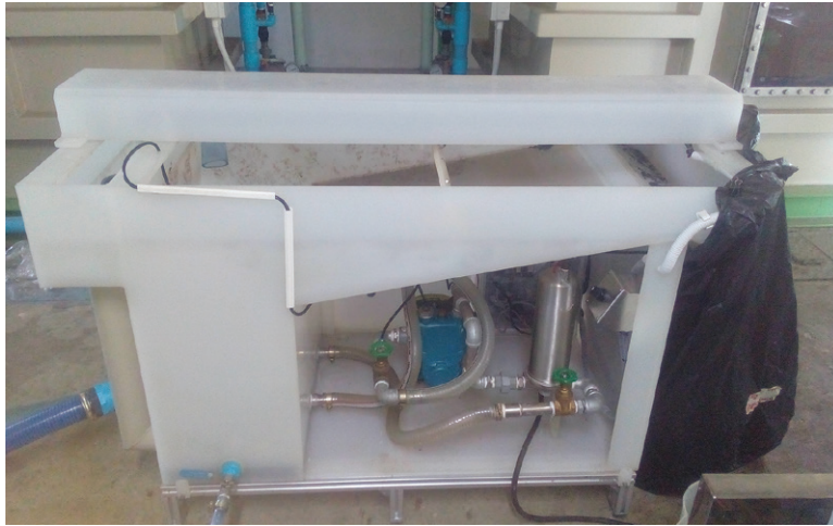
รูปที่ 1 ถังแยกไขมันด้วยฟองอากาศแบบละเอียด
