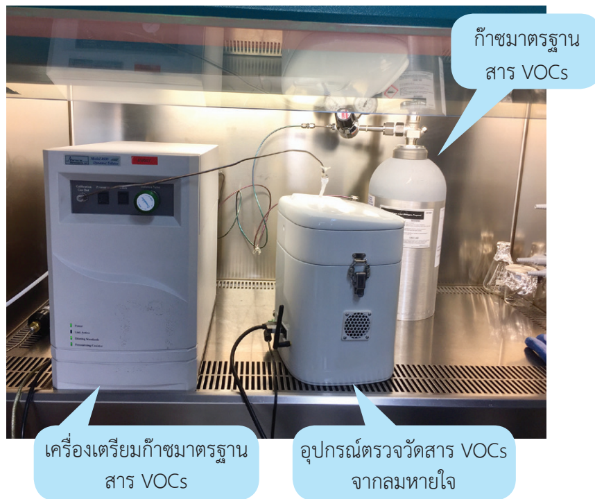
รูปที่ 3 สร้างโมเดลการแปลงค่าจากเซ็นเซอร์ด้วยการสอบเทียบกับก๊าซมาตรฐานสาร VOCs ที่ความเข้มข้น 5 10 และ 25 ppbv
