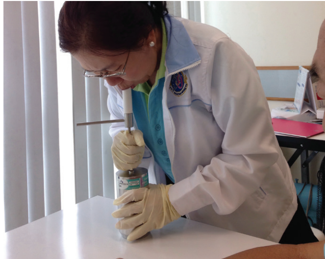
รูปที่ 1 แสดงเก็บตัวอย่างสาร VOCs จากลมหายใจ
