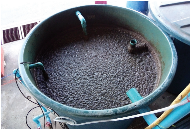
รูปที่ 2 แสดงไขมันที่แยกจากน้ำเสียโดยฟองอากาศ
